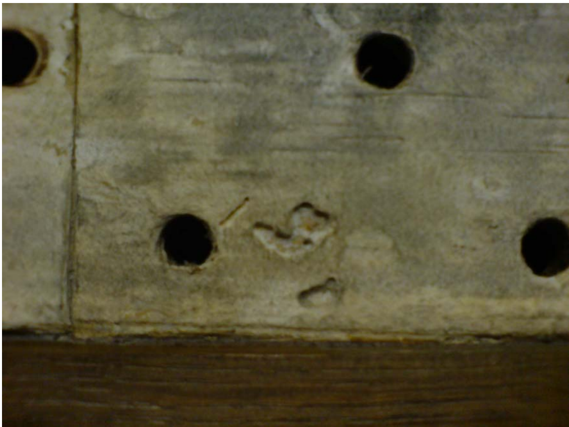
049 Kanzellen nach Ablösen der Belederung
