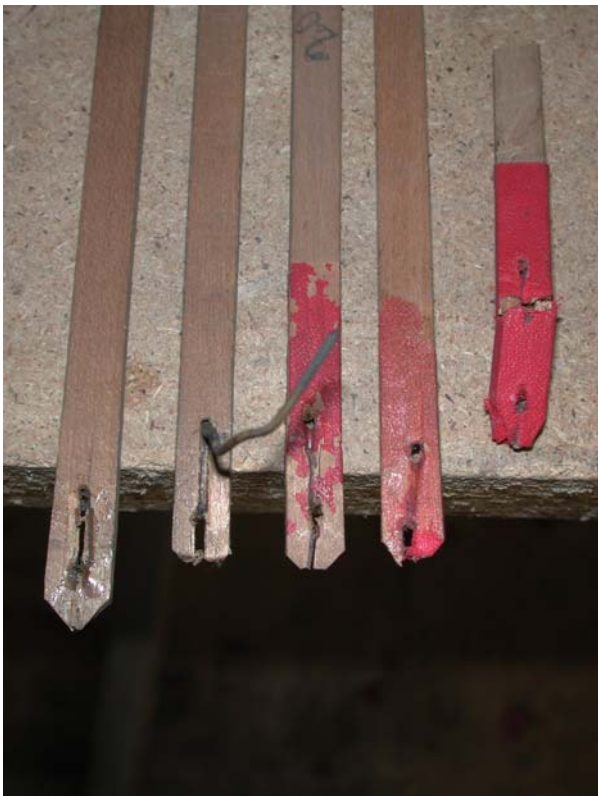
037 - 040 Details von Wellen und Abstrakten vor der Restaurierung
