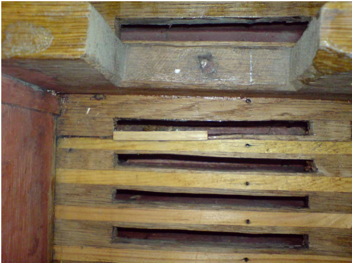
049 Kanzellen nach Ablösen der Belederung
